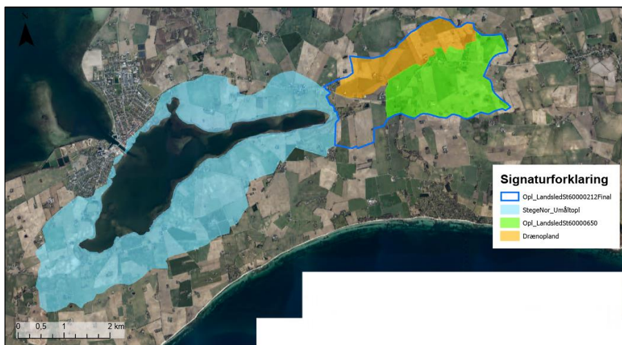
Figur 3: Oversigt over oplande til Stege Nor. Bemærk at oplandene er estimeret dels ud fra SDFE-landsdækkende 1. ordens oplande samt den digitale højdemodel (DTM/Terræn 0,4 m grid, 2017). Ortofoto hentet via Styrelsen for Dataforsyning og Effektivisering, marts 2022.
